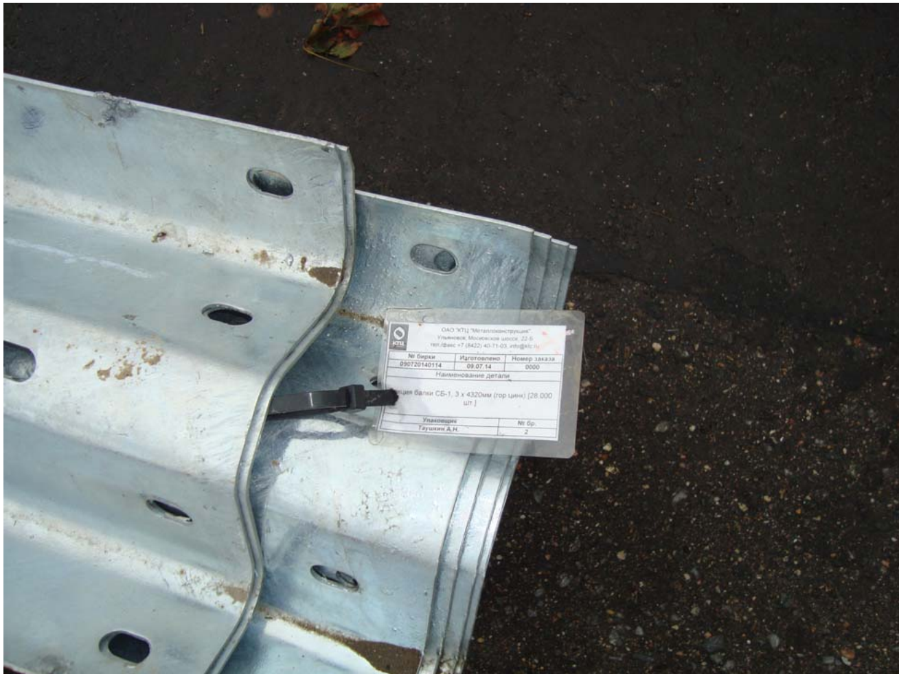
Оцинкованный профиль будущего отбойника. Качество материалов - ГОСТ.
